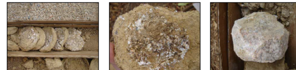
Fig. 14. Testigos Granito Caja 2. Fig. 15. Detalle textura del Granito. Fig. 16. Detalle textura diques de pórfido.
