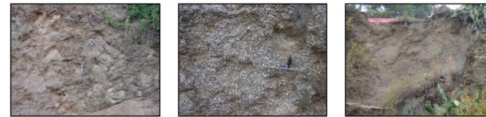
Fig. 11. Granitos alterados grado II. Fig. 12. Granitos alterados grado III. Fig. 13. Granitos alterados grado III-IV.
